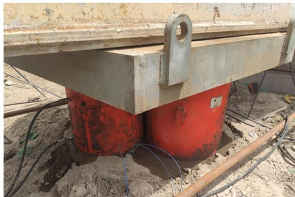
图4 现场液压加载图
